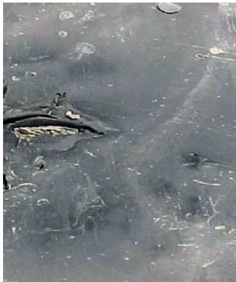
FIGURA 4.4. GEOMEMBRANA ROTA EN RELLENO SANITARIO.
