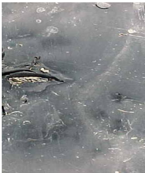
Figura 4.4. Geomembrana rota en relleno sanitario.
