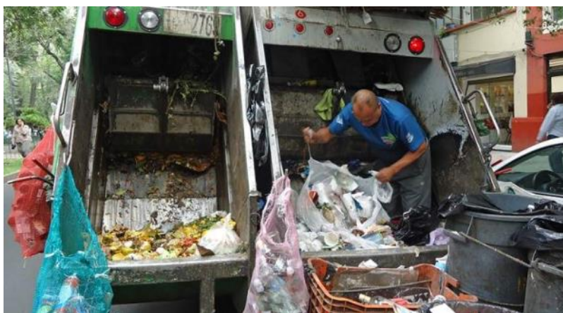
Imagen 18. Vehículo recolector con compartimientos separados.
