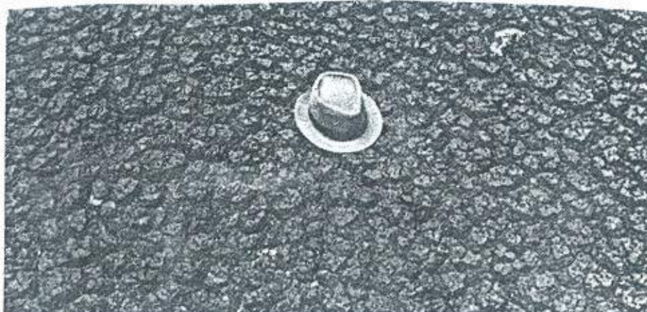
Foto mostrando lodo digerido bem seco, em leito de secagem.
