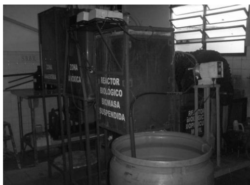
Figura 2. Sistema de reactores biológicos que conforman el sistema de tratamiento tipo bioactivado RDS.
