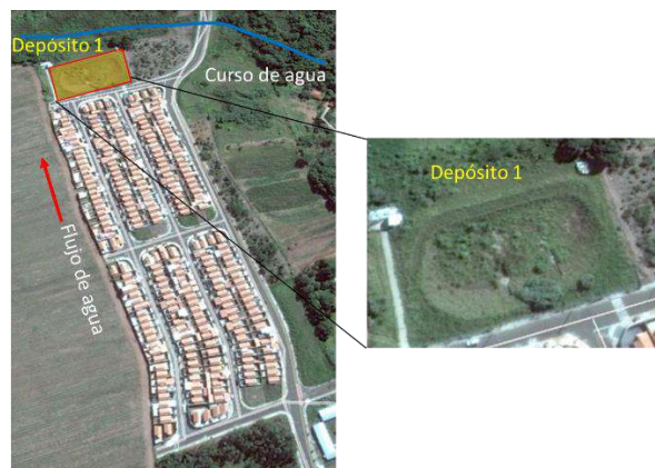
Imagen 1. Vista aérea de depósito de detención (depósito 1)
