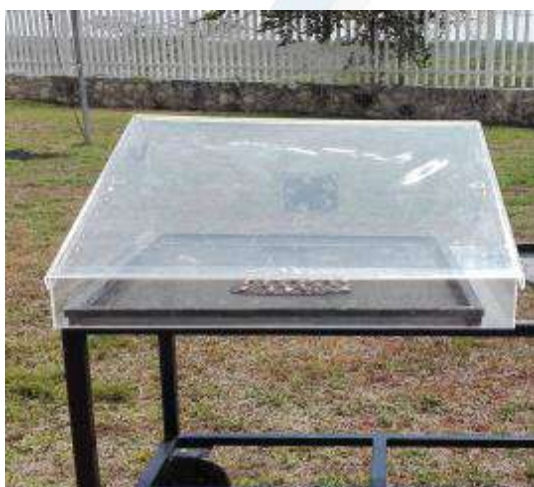
Figura 1 Secador solar directo tipo gabinete
