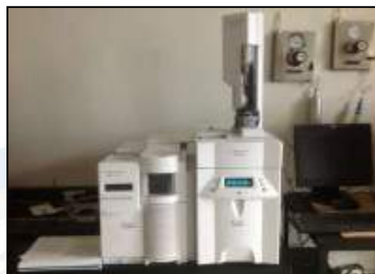
Fotografía 3. Cromatógrafo de Gases acoplado a Espectrómetro de Masas usado para el análisis de los productos de la reacción de transesterificación.
