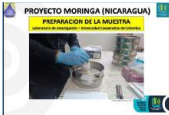
Figura 4. Proceso de tamizado de la moringa molida en tamices de tamaño inferior a 00 micrómetros.
