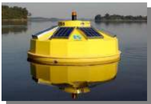
Figura 3 – Boia de coleta e ensaio automatizados
