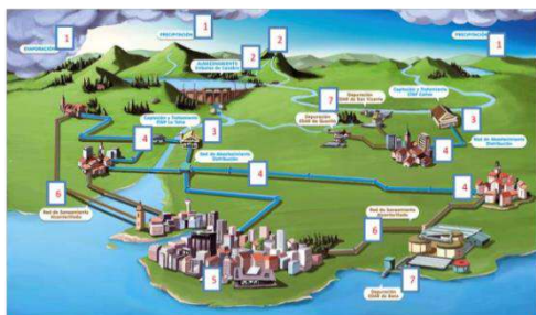
Imagen 8.- Esquema del abastecimiento y saneamiento metropolitano de A Coruña
