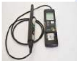
Figura 1: Aparelho medidor de CO 2 – Testo – modelo 535
