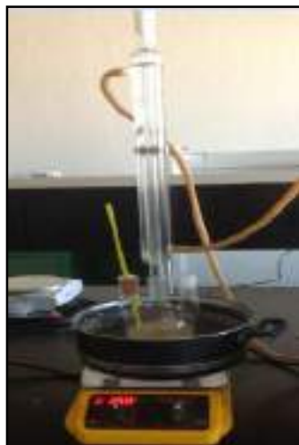
Fotografía 1. Montaje experimental a nivel laboratorio para la transformación de grasas residuales hacia biodiésel
