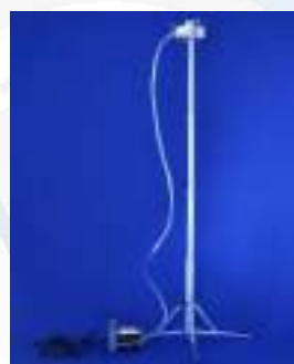
Figura 2: Amostrador de Bioaerosol - BCF.01 - modelo CF-6.
