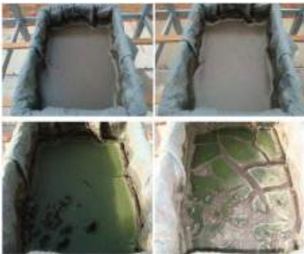
Figura 5. Evolução da bandeja com lodo retirado do decantador de coluna com 1, 2, 5 e 10 dias de secagem respectivamente
