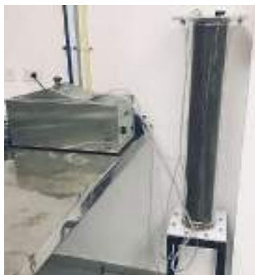
Figura 2. Reactor SBR empleado para el tratamiento del glifosato.
