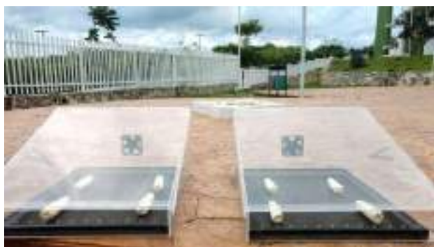
Figura 1 Secador solar directo tipo gabinete.
