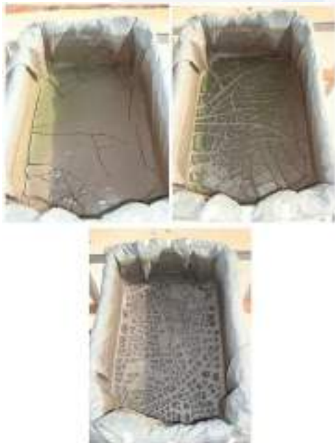
Figura 6. Lodo retirado do floco decantador com 3, 5 e 7 dias de secagem respectivamente
