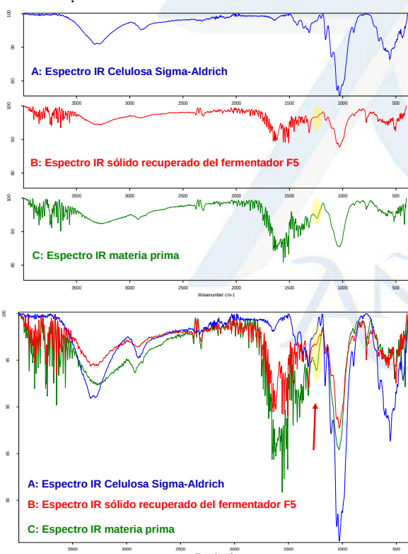
Figura 4. Comparación de espectros infrarrojos de la celulosa, la materia prima y el sólido recuperado del fermentador F5.
