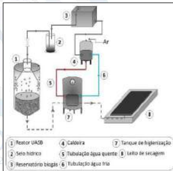
Figura 1. Representação esquemática do aproveitamento térmico do biogás no tanque de higienização seguido de leitos de secagem.
