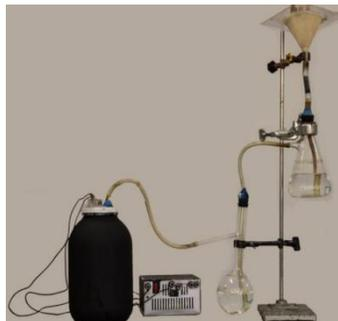
Figura 4. Diseño experimental para extraer alquitrán
