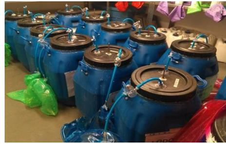
**Figura 3. Reactores usados en la digestión**
