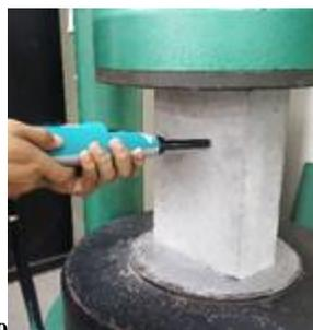
**Figura 3 - Ensaio esclerométrico**
