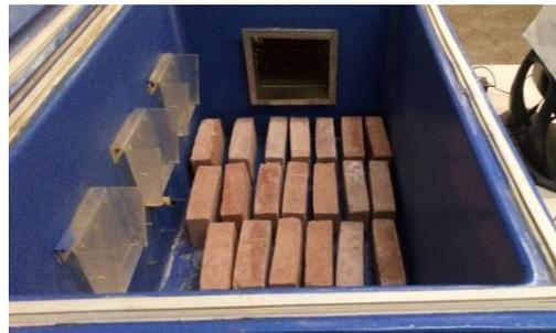
Asistencia Técnica en Materiales (UDIATEM) en el Laboratorio de Corrosión del Departamento de Mecánica de la Facultad de Ingeniería, para ello se utilizó una cámara en la cual se simularon humedad y temperatura similares a las de la ciudad de Durango con un ciclo de 12 minutos equivalentes a un día, los ciclos se repitieron hasta completar 1 año de envejecimiento de acuerdo a la ASTM C67 (figura 6).
