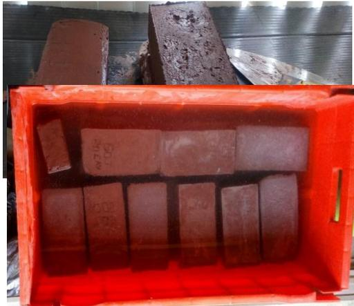
Los ladrillos se dejaron secar durante dos días, con el fin de que se pudieran manipular fácilmente y transportar a un contenedor para el proceso de curado mediante inmersión en agua. La fotografía 3 ilustra el curado de los ladrillos.
