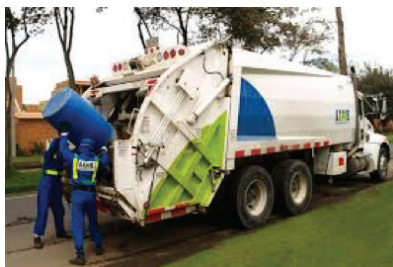
Figura 4.14 y 4.15 Camiones de carga posterior y con sistema de alzacontenedores
