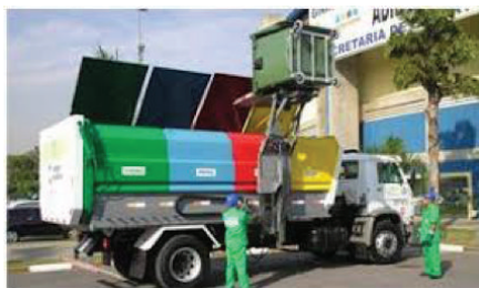
Figura 4.17 y 4.18 Camiones especiales para reciclaje y recolectores de carga lateral
