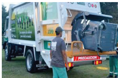
Figura 4.14 y 4.15 Camiones de carga posterior y con sistema de alzacontenedores
