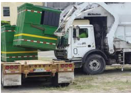
Figuras 4.19 y 4.20 Recolectores de carga frontal, camiones (roll on-off) levanta grandes contenedores
