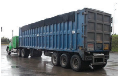
Figuras 4.23 y 4.24 Trailers de transferencia con cajas sin compactación
