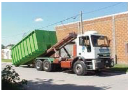
Figuras 4.19 y 4.20 Recolectores de carga frontal, camiones (roll on-off) levanta grandes contenedores
