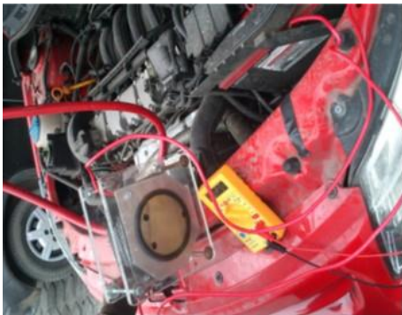
Figura 3. Los amperios óptimos que alimenta la celda, dependerá del motor.
