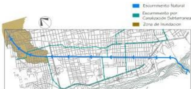
Figura 3. Dirección del flujo y sus escurrimientos Subterráneos así como zona de inundación.
