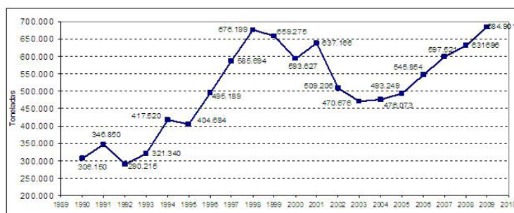
Figura 1: Residuos sólidos (ton/año) ingresados hasta 2010 al Sistema de Disposición Final IMM. La disminución de residuos en 2003 coincide con la bancarrota del país en 2002 y la subsiguiente crisis.
